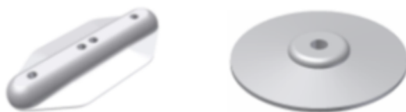
Ilustracja 1.1 Uszczelka wewnętrzna i zewnętrzna tarcza ustalająca, odpowiednio
