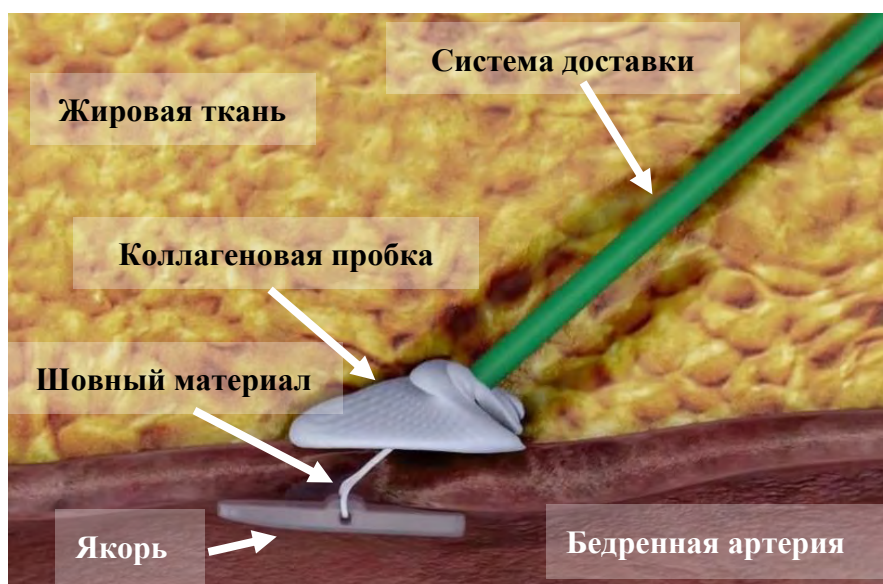
Рис. 1.1 Устройство для герметизации пункции артерии Angio-Seal™ VIP VCD
