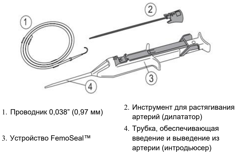
Рис. 2.1 Устройство FemoSeal™ VCS с проводником и дилататором
