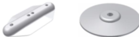
Figura 2.2 Vedante interno e disco de bloqueio externo, respetivamente
